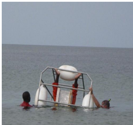
« Cage » S.W.E.T (Shallow Water Escape Trainer) Simulant une cabine d'hélicoptère
