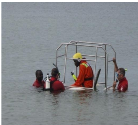
« Cage » S.W.E.T (Shallow Water Escape Trainer) Simulant une cabine d'hélicoptère
