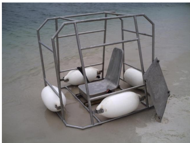
« Cage » S.W.E.T (Shallow Water Escape Trainer) Simulant une cabine d'hélicoptère
